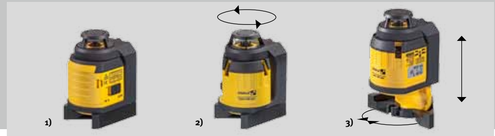
1 — положение при транспортировке. 2 — подвижную часть прибора можно поворачивать внутри корпуса прибора на 360°. 3 — благодаря регулируемой по высоте ножке можно регулировать лазерную линию по высоте. Нижняя опорная часть прибора позволяет устанавливать лазерный прибор, например, на U-образные металлические профили для сухой штукатурки.
